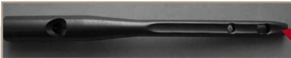
Модификация стандартного проксимального бедренного фиксатора (ПБФ): дистальное круглое отверстие преобразовано в овальное для проведения блокировочных винтов (**Патент № 2473317 РФ**).
